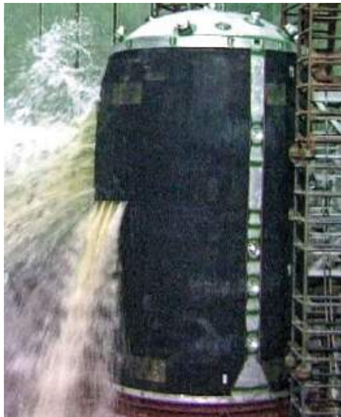
Топливный бак ракеты 15A18M во время отработки на внутреннее давление
