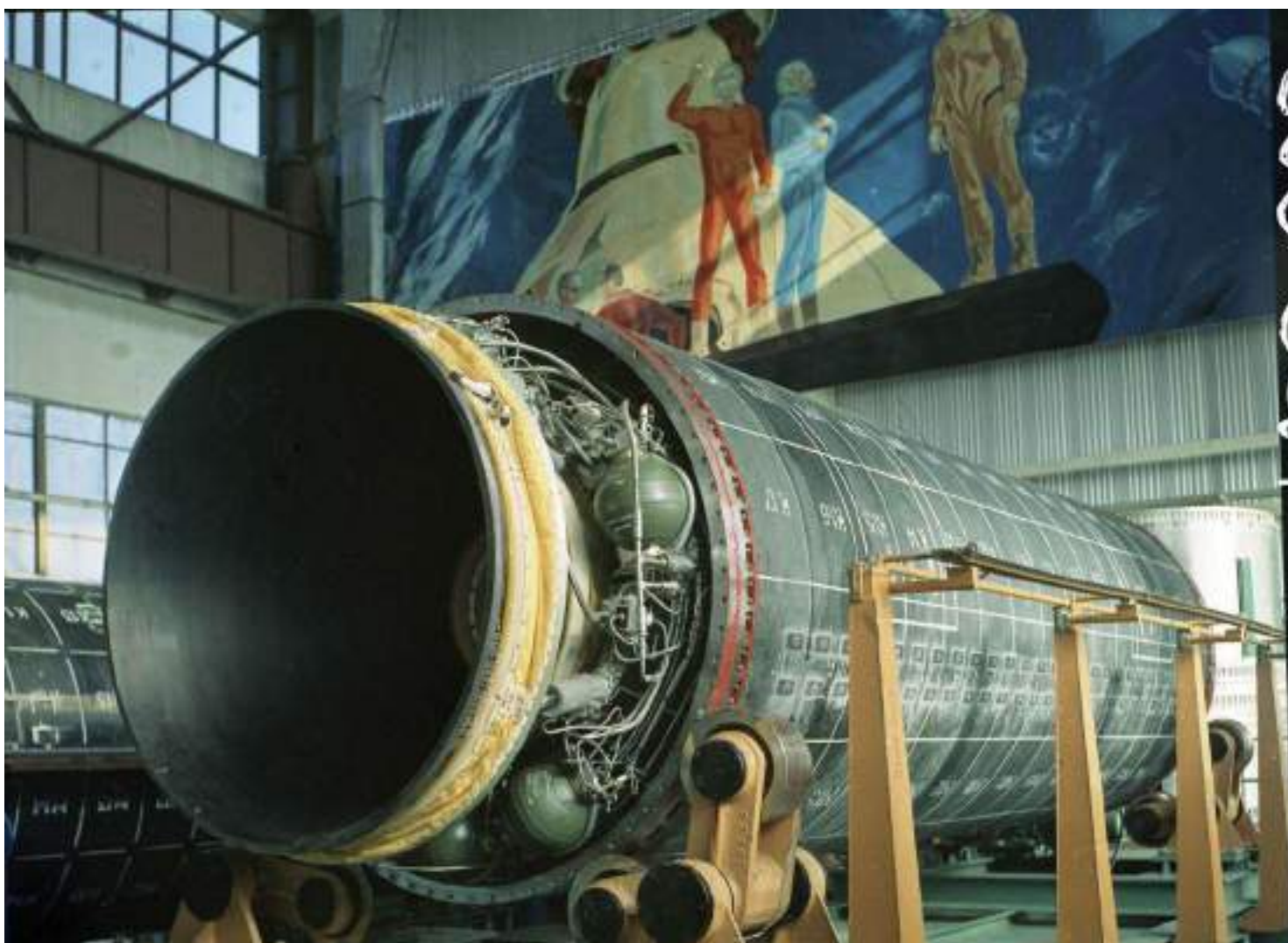
Маршевый твёрдотопливный двигатель первой ступени с поворотным соплом, оснащённым ЭОШ
