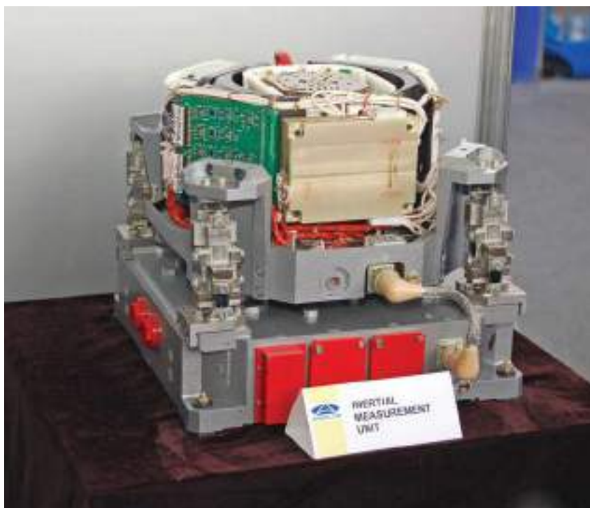
Бесплатформенная инерциальная навигационная система (БИНС) для системы управления РН «Циклон-4»
