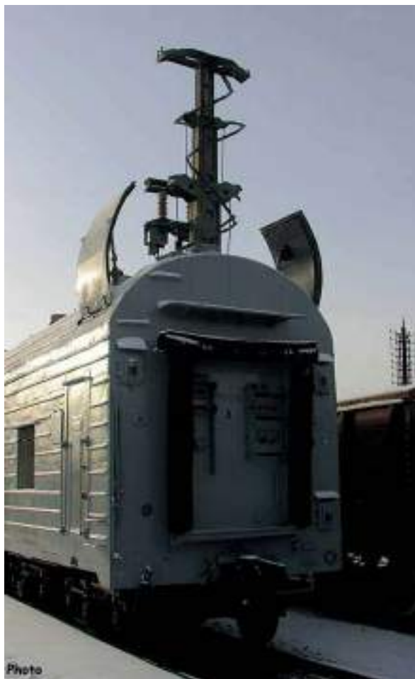
Устройство «закорочивания» и отвода контактной сети
