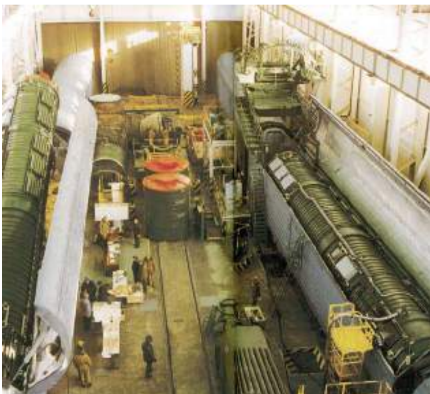
Укладка ТПК в вагоны БЖРК на Павлоградском механическом заводе
