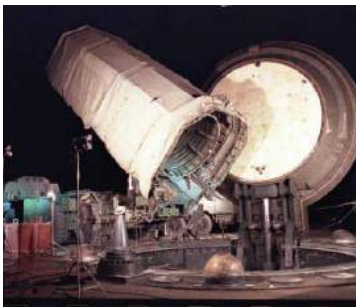
Пристыковка обтекателя головной части к ракете в ШПУ
