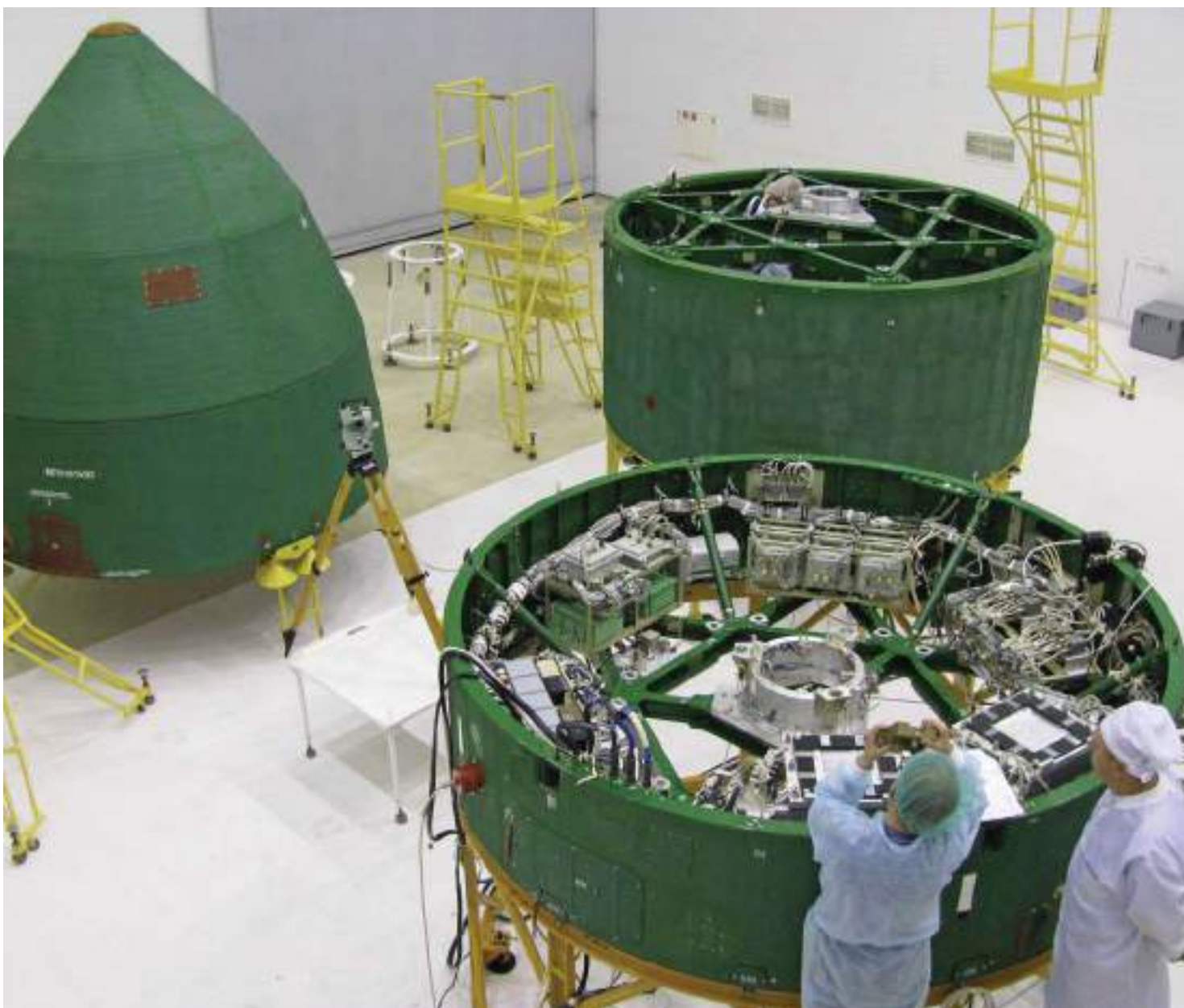
Установка блоков БИНС в космическую головную часть РН «Днепр» для проведения летных испытаний
